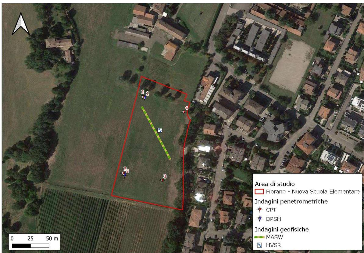
Figura 8 - Ubicazione delle indagini penetrometriche e geofisiche eseguite all'interno dell'area di studio.
