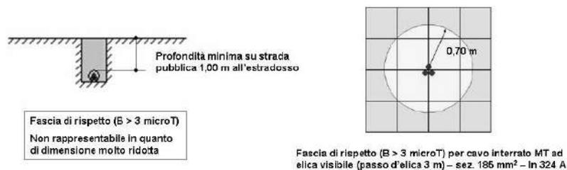
**La realizzazione degli edifici di progetto dovrà tenere in considerazione la presenza della cabina di trasformazione MT/BT e della linea MT interrata, con le relative DPA specificate. Con riferimento a eventuali ulteriori linee MT interrate si rimanda alla fase di progettazione**
