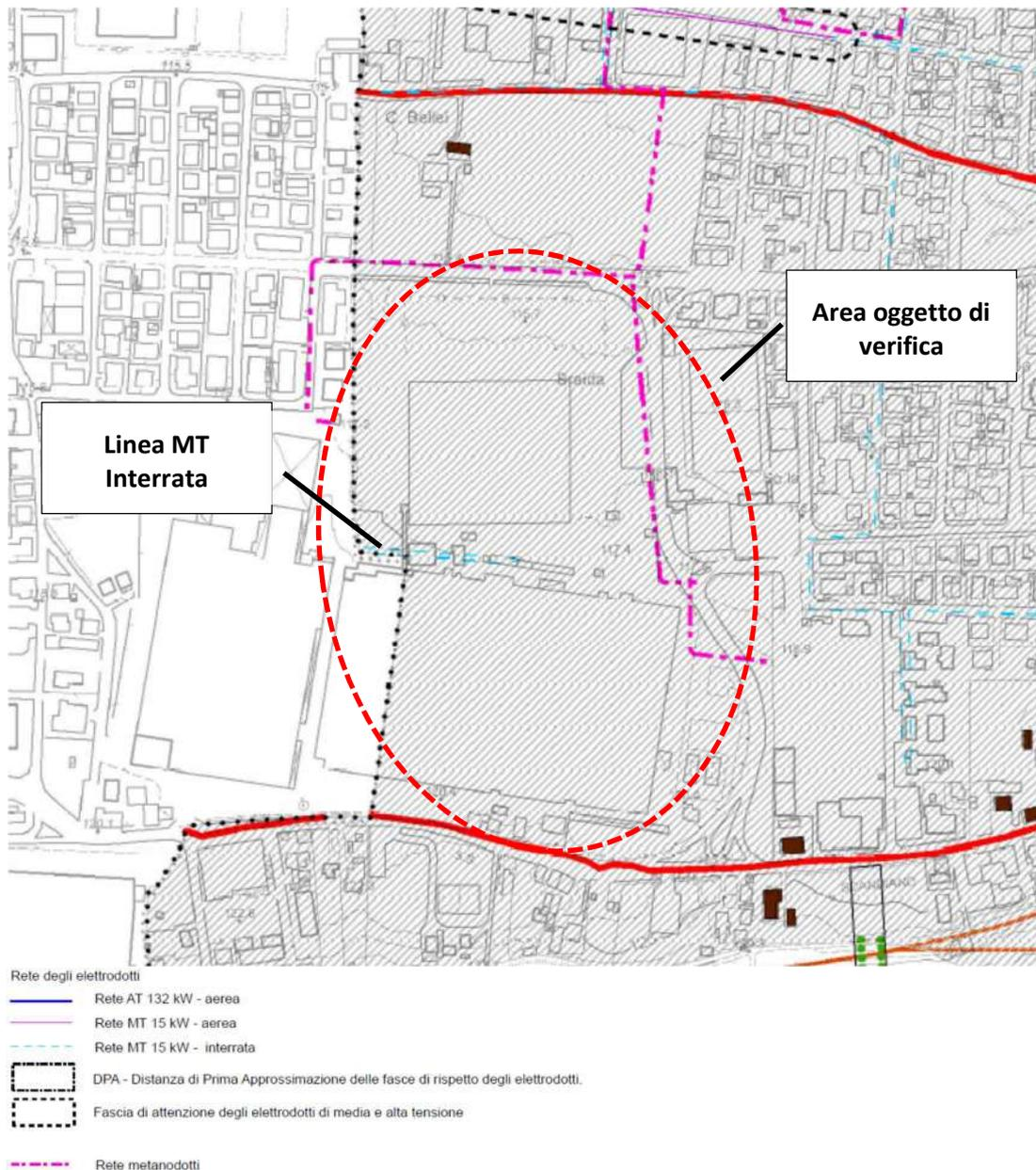
Le procedure di calcolo per le fasce di rispetto si riferiscono al Decreto Ministeriale del 9/05/2008 (GU n. 156 del 5 luglio 2008) "Approvazione della metodologia di calcolo per la determinazione delle fasce di rispetto per gli elettrodotti". Occorre sottolineare che la
