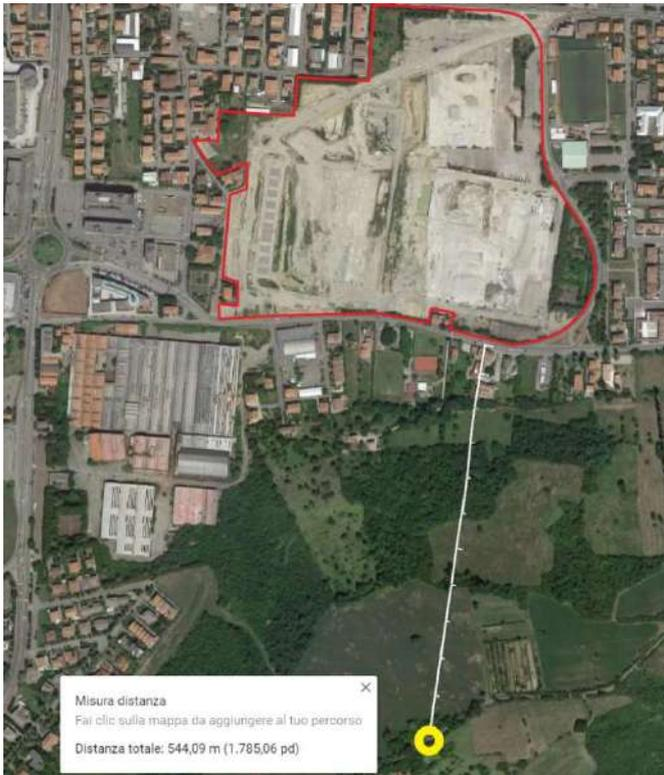
I sopralluoghi effettuati unitamente ai ragguagli cartografici hanno portato ad individuare la presenza di 3 Stazione Radio Base a distanza tale da non avere le potenzialità di interferire con gli edifici di progetto (distanza > 200 m), previsti per la nuova riqualificazione del lotto ex Cisa Cerdisa.
