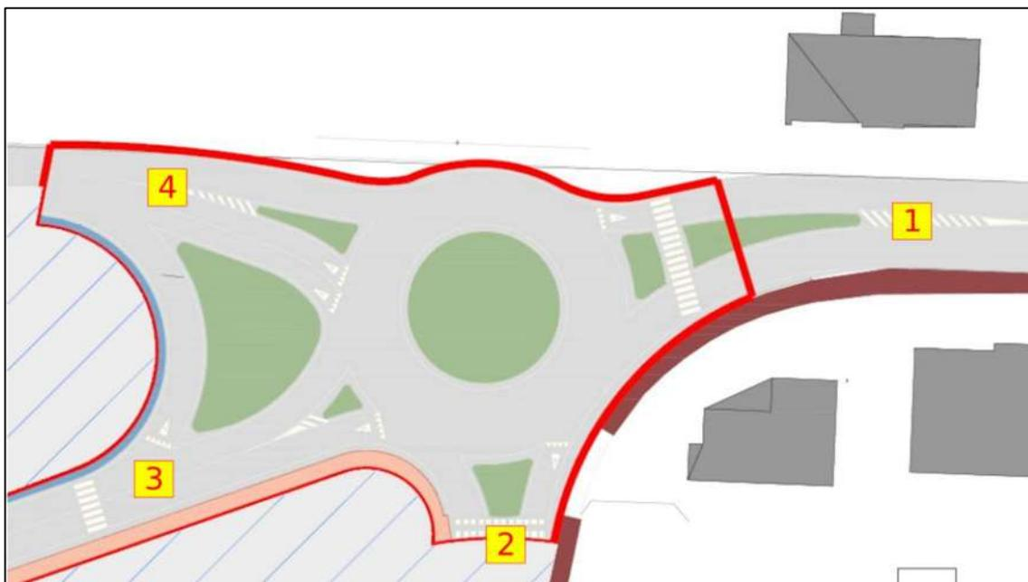
Il funzionamento della Rotatoria N nello scenario di Progetto è caratterizzato da una domanda pari a 2.803 veic/h durante l'ora di punta della sera; rispetto allo scenario Ante Operam, nel quale l'intersezione era interessata da 2.417 veic/h, si riscontra dunque un aumento del 16% circa.
