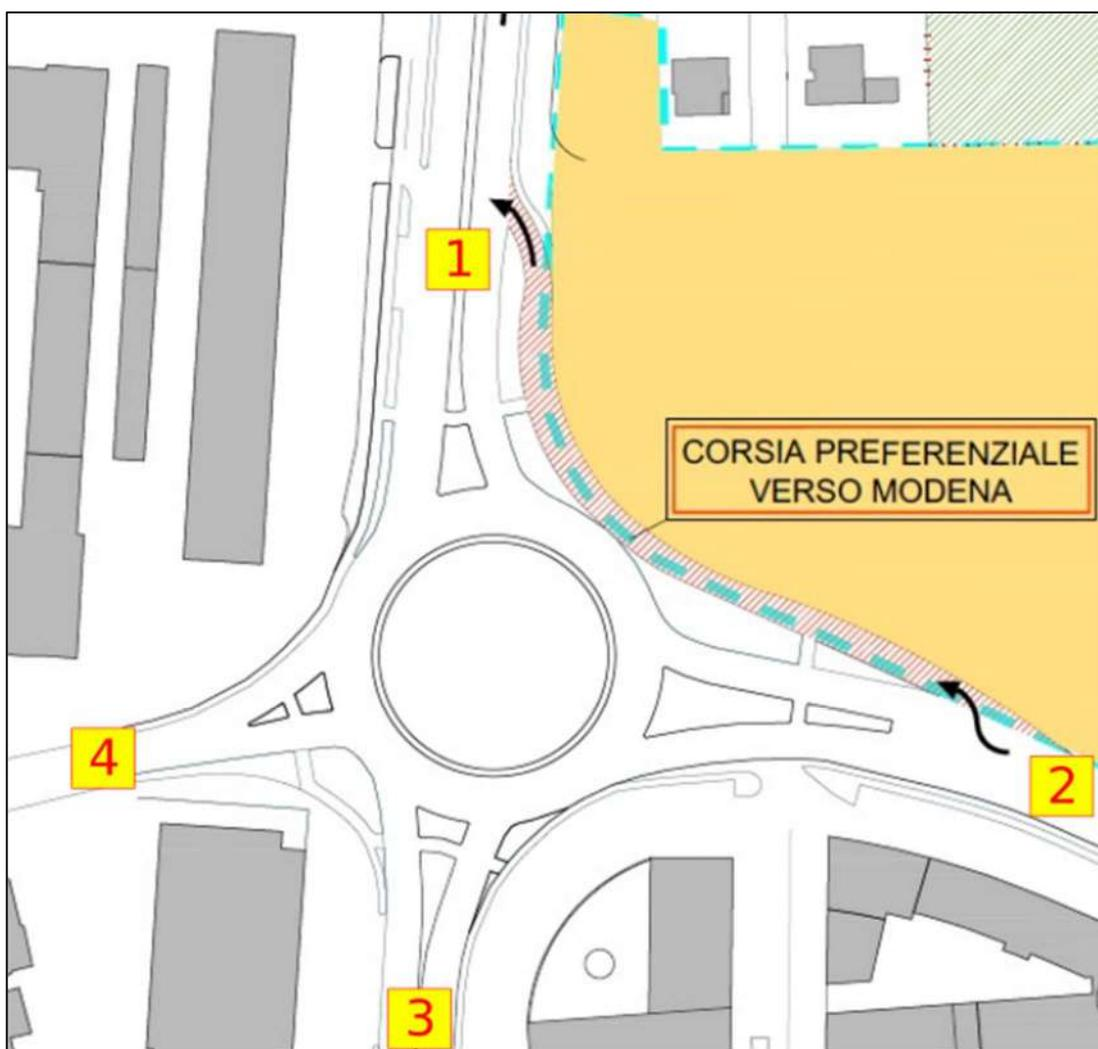
Nello scenario di Progetto la rotatoria mantiene la stessa configurazione geometrica dello scenario Ante Operam, l'unico intervento previsto sull'intersezione è l'introduzione di un bypass in direzione est-nord da Via Adda est a via Circonvallazione Sud-Est.
