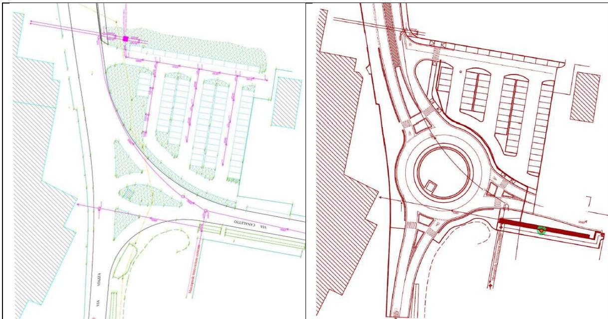
Figura 9 – Attuale incrocio (sinistra) e schema della rotatoria in progetto (destra) lungo via Viazza-via Canaletto (da Nuova Rotonda via Canaletto-via Viazza – Documentazione idraulica, a cura di Dott. Geol. Gemelli Franco, aprile 2018).
