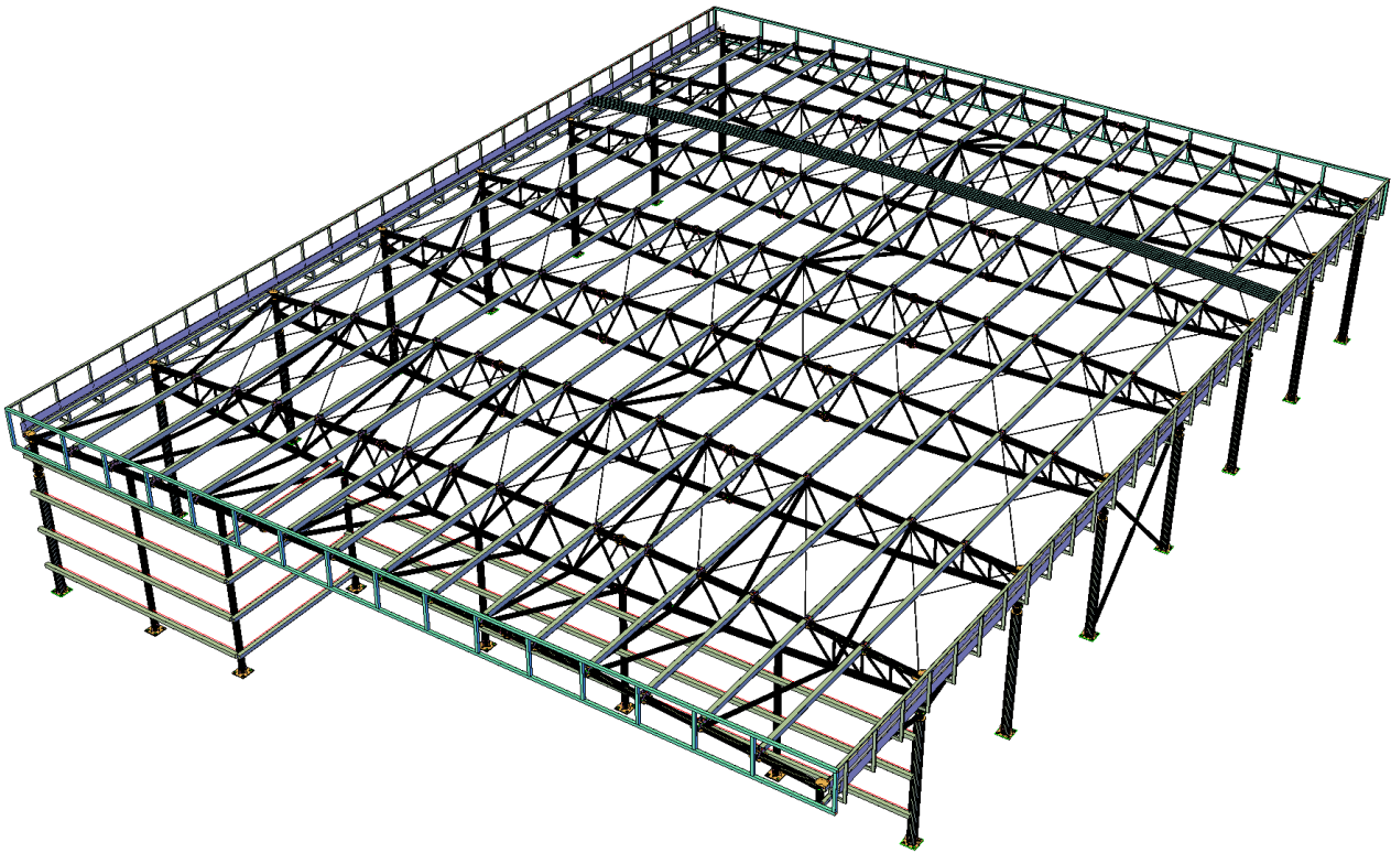
Figura 1 – Vista 3D struttura metallica Scarabeo Entertainment
