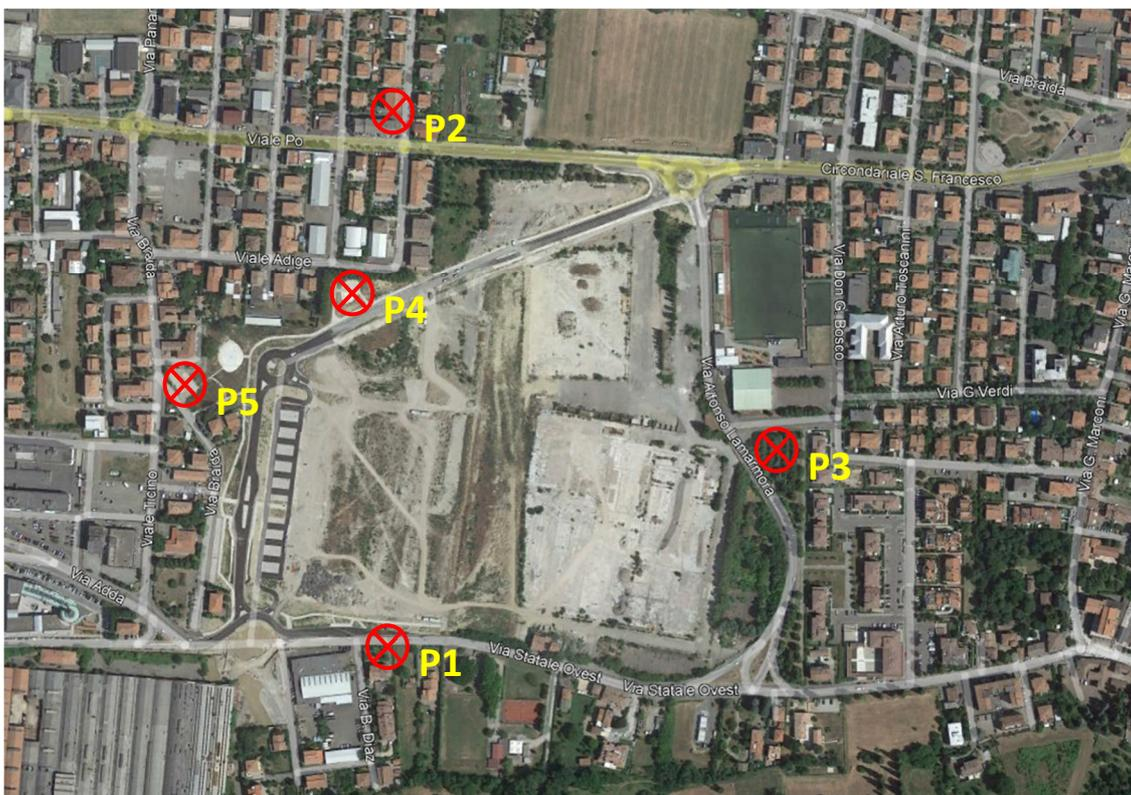
Il rilievo di lunga durata permette di rendere immediatamente confrontabile la rumorosità in riferimento ai limiti di zona per i periodi di riferimento diurno (6.00-22.00) e notturno (22.00-6.00), come previsto dalle norme vigenti. In questo senso il dato fornisce un primo e importante elemento di descrizione del clima acustico.
