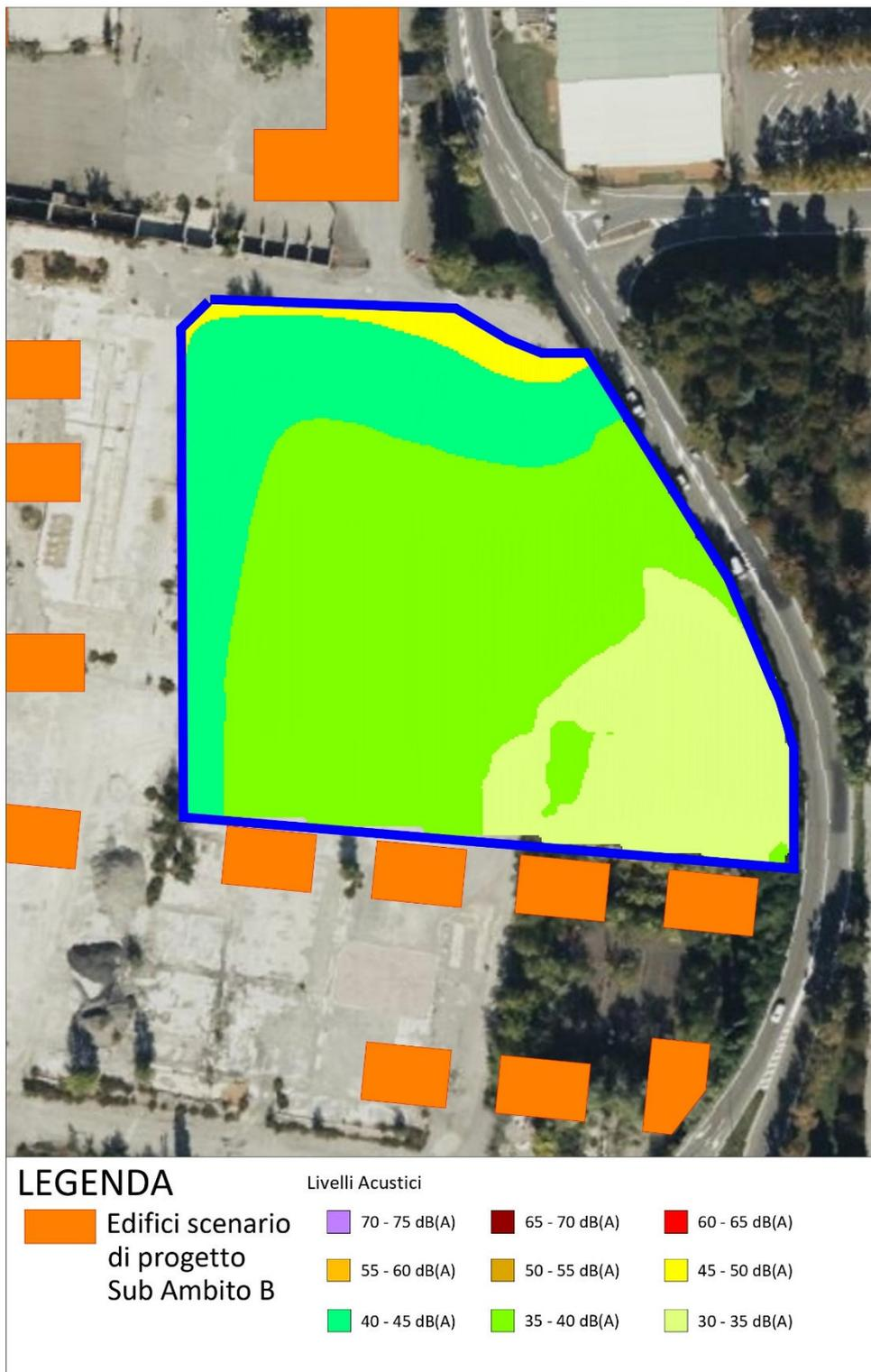
Dall'analisi delle mappe di rumore soprariportate emerge come, agendo sulla distribuzione delle volumetrie e sulle altezze massime degli edifici (le mappe sono state simulate a 4m di altezza dal p.c.), sia possibile l'insediamento di edifici a destinazione sensibile come usi scolastici o sanitari, per i quali è previsto l'inserimento in I Classe acustica.
