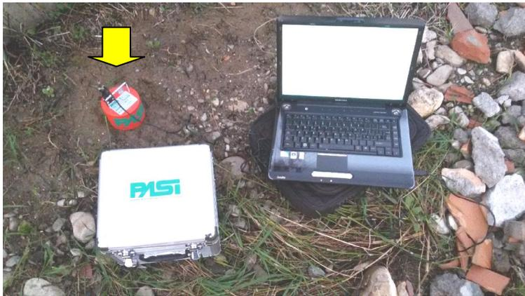
del segnale, avviene ponendo sul terreno un tomografo digitale al cui interno ci sono tre sensori elettrodinamici (velocimetri) ad alto guadagno disposti nelle tre direzioni dello spazio. I segnali acquisiti a loro volta sono sottoposti ad una fase di
