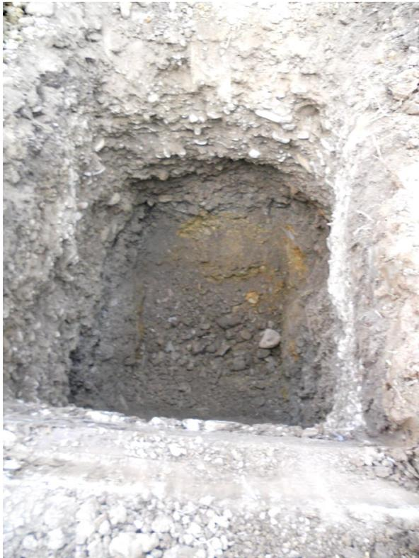
Particolare del saggio **S2** con la presenza di ghiaie eterogenee su tutta la profondità investigata con un arricchimento in materiali fini giallastri poco oltre i due metri. A questa profondità si osserva un incremento del contenuto d'acqua.
