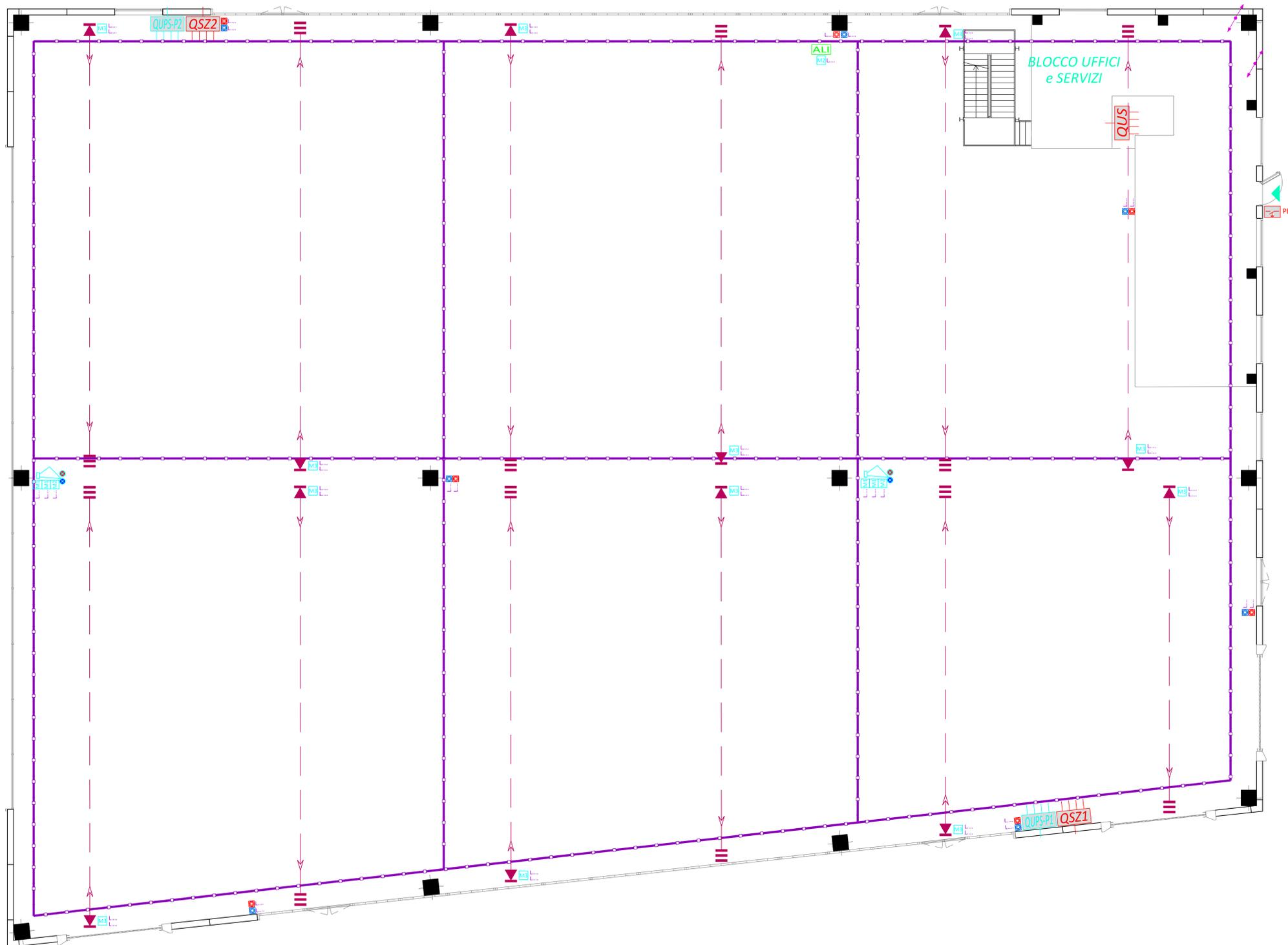
Particolare IMPIANTO AUTOMATICO RILEVAZIONE E ALLARME INCENDI NORMA UNI 9795 negli UFFICI e SERVIZI - PIANO TERRA -
