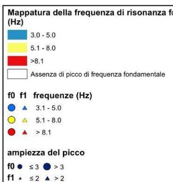
L'indagine HVSr, registrazione con tromografo di rumore sismico ambientale di fondo (microtremore), si pone come obiettivo preminente l'individuazione delle diverse frequenze di risonanza del terreno il tutto, nell'ottica di valutare eventuali fenomeni di amplificazione del moto sismico nel terreno d'indagine.
