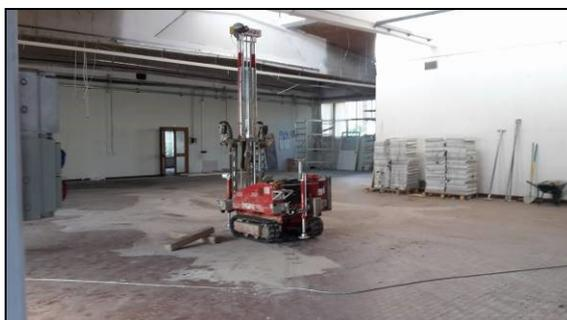
Per la prova eseguita, ubicata in Figura 13, si è utilizzato un **penetrometro pesante (DPSH)**, certificato dalla Ditta Pagani Geotechnical Equipment di Piacenza, con caratteristiche tecniche riassunte nella tabella seguente:
